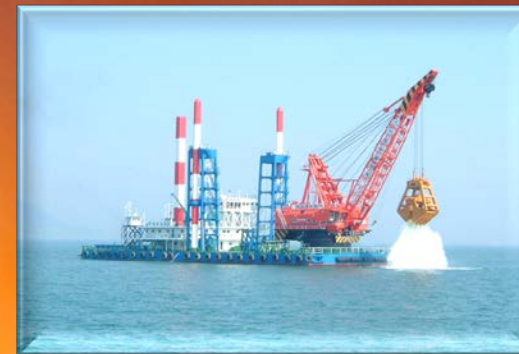
27m級浚渫船「27金剛」 大規模浚渫が得意としております スパッドを装備し、他船の航行を妨げません 200t吊起重機船としても使用可能です
