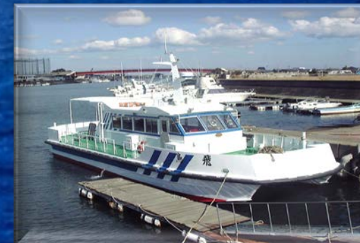
1,040PS級高速交通船「飛鳥」 双胴船なので安定性抜群！ スピーディな人員の移動が得意です
