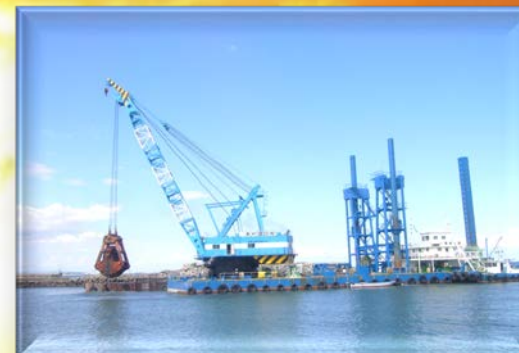
13m級浚渫船「第2金剛」 中規模な浚渫が得意です スパッドを装備し、他船の航行を妨げません
