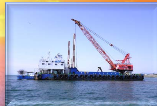
125t吊起重機船「青竜」 スパッド装備で狭い港内での クレーン作業が得意です 650mのホールドを備えています
