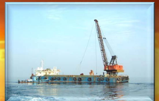
3.5m級浚渫船「葵3号」 小規模な浚渫が得意です 890mのホールドを備えています
