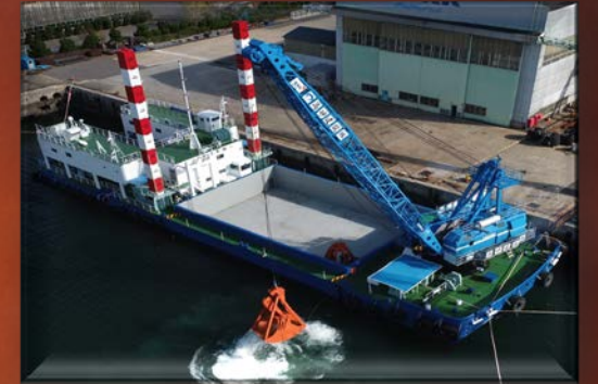
4m級浚渫船兼100吊起重機船「葵5号」 小規模浚渫・据付作業が得意です スパット・スラスタ・プッシャー船を装備し高機動です 910mのホールドを備えています
