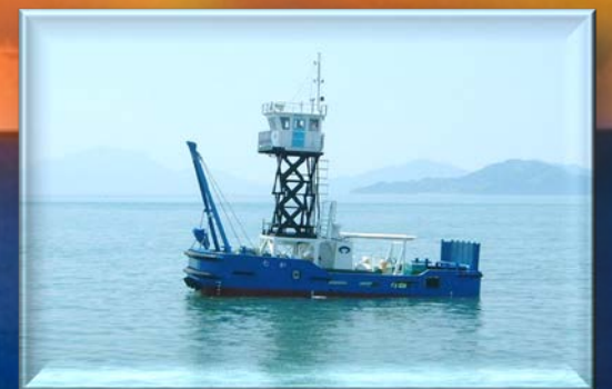
1,800PS級押船兼揚船「はと」 昇降式ブリッジを備え 起重機船やバージの移動が得意です
